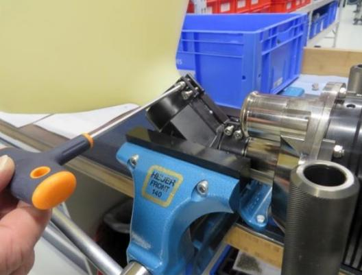
4. Spannen Sie die RFC-04-HC/ RFC-05-HC mit Hilfe eines **Schraubstocks** soweit vor, bis die M5x16 Schrauben problemlos montiert werden können und richten Sie die Flasche zur Betankungskupplung wie gezeigt aus. Verwenden Sie **glatte Backen**, um Beschädigungen und Kratzer an der Schlauchschelle zu vermeiden.
